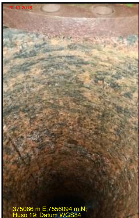
Foto 15: Ducto circulación auxiliar después de la limpieza
